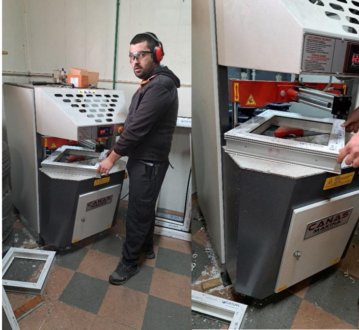
Figura 4.1.2.6. Pastrimi i lidhjeve të salduara të profileve PVC
