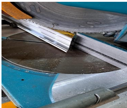
Figura 4.1.2.12. Prerja e elementeve të punës prej profileve të aluminit
