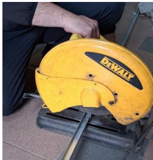
Figura 4.1.2.3. Prerja e përforcimeve të profileve PVC
