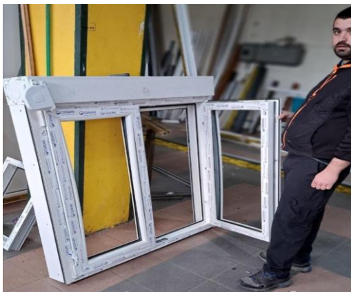
Figura4.1.2.9. Një dritare PVC në fazën përfundimtare në punishte (xhamat instalohen në vendin e montimit)
