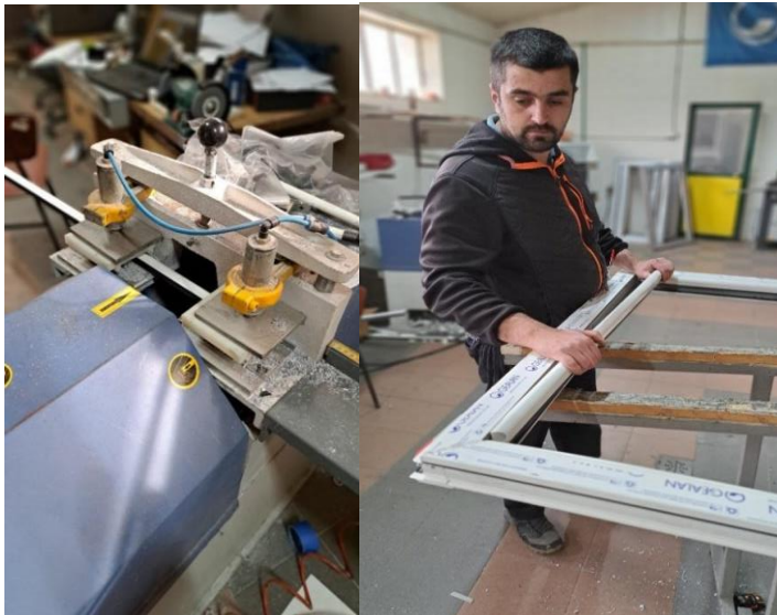
Figura 4.1.2.7. Prerja e listelës (majtas) dhe montimi i listelës te krahu i dritares PVC (djathtas)
