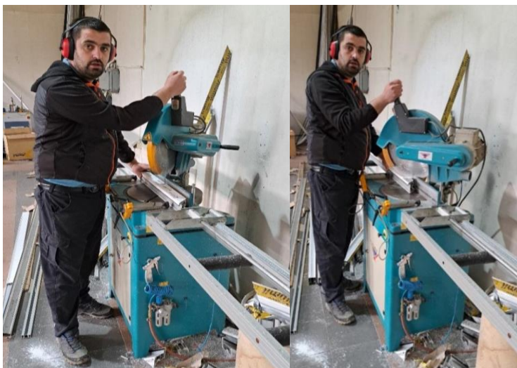
Figura 4.1.2.2. Prerja e profileve PVC në kënde të ndryshme prej 45°
