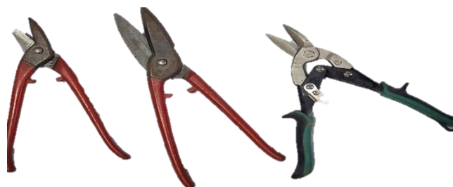
Figura 2.1.2.3. Gërshërë manuale për prerje
