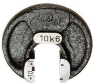
Figura 1.2.1.1. Matës i njëanshëm për kontrollin e
