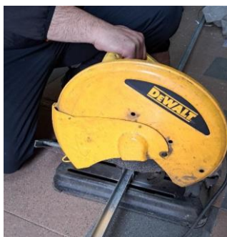
Figura 4.1.2.3. Prerja e përforcimeve të profileve PVC
