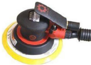
Figura 2.2.2.1. Makina retifikuese manuale pneumatike për retifikim me letër zmeril të rumbullakët
