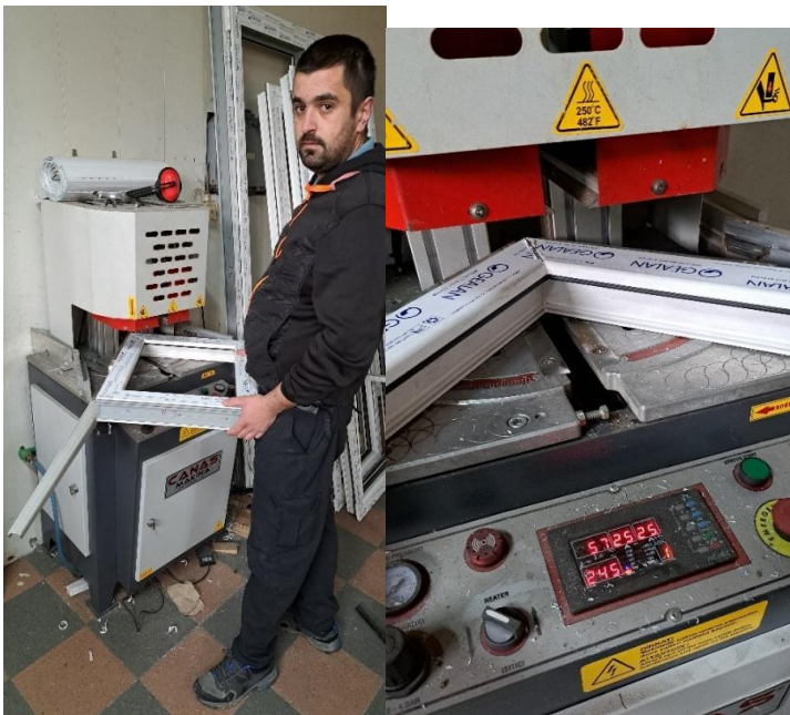
Figura 4.1.2.5. Bashkimi i këndeve të profilin PVC
