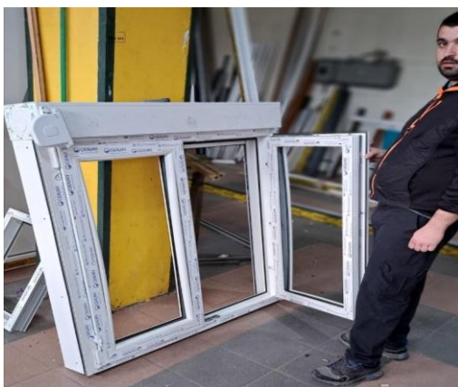
Figura4.1.2.9. Një dritare PVC në fazën përfundimtare në punishte (xhamat instalohen në vendin e montimit)
